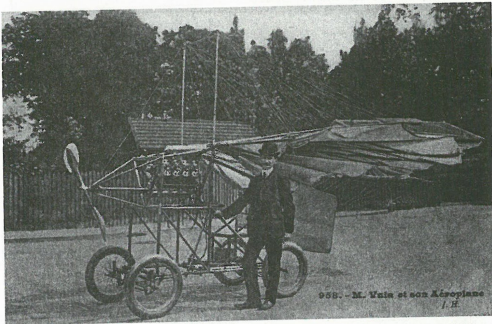
Carte poștală realizată în Franța în anul 1907 în care apare Traian Vuia lângă aeroplanul său „Vuia nr. 2“. Aparatul este cu aripile repliate, fapt ce permite să se observe motorul Antoinette.
